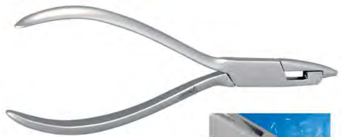
DO.710.200 Tweed Loop forming pliers with replaceable 440 stainless steel tip, three step tip has 1.14, 1.52 and 1.91mm diameters Kleszce do formowania pętli z wymienną, trójstopniową końcówką (1.14 mm, 1.52 mm, 1.91 mm) ze stali nierdzewnej 440
