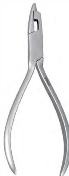
DO.700.200 Omega Loop forming pliers with replaceable 440 stainless steel tip, three step tip has 1.14, 1.52 and 1.91 mm diameters Kleszcze do formowania pętli z wymienną, trójstopniową końcówką (1.14, 1.52, 1.91 mm) ze stali nierdzewnej 440 ● Max. 0.36 mm to 0.64 mm (.014" to .025") ■ Max. 0.53 mm x 0.64 mm (.021" x .025")
