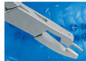
DO.700.200 Omega Loop forming pliers with replaceable 440 stainless steel tip, three step tip has 1.14, 1.52 and 1.91 mm diameters Kleszcze do formowania pętli z wymienną, trójstopniową końcówką (1.14, 1.52, 1.91 mm) ze stali nierdzewnej 440 ● Max. 0.36 mm to 0.64 mm (.014" to .025") ■ Max. 0.53 mm x 0.64 mm (.021" x .025")
